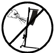
**3.7** - Si existe la posibilidad de vientos fuertes o ráfagas, coloque el elevador en el suelo con firmeza y fijelo mediante tirantes tensores. Nunca fije un tirante a un vehículo o cualquier otro objeto que se pueda mover.
