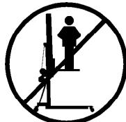
**3.1** - La torre elevadora TP-20 es una máquina diseñada para la elevación de cargas en dirección vertical. NUNCA se debe utilizar como plataforma eleavadora de personas.
